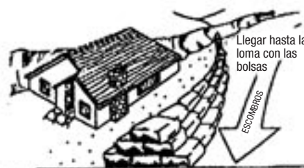
DIRIGIR LOS ESCOMBROS LEJOS DE LOS EDIFICIOS
